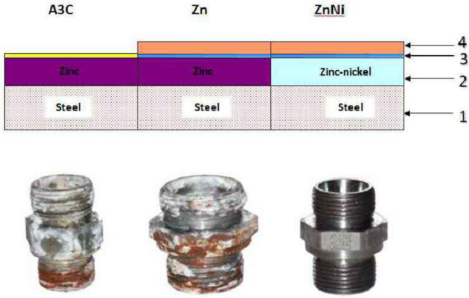
Şekil 3. 120 Saat tuzlu su testinden sonra farklı yüzeylerin kaplama yapısı karşılaştırması.
