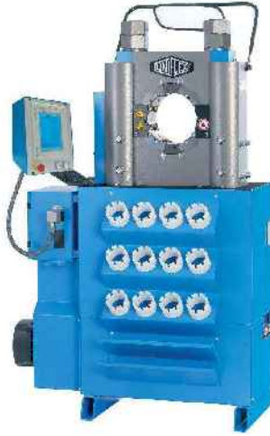
Resim 2. Hidrolik hortum rakoru montaj makinesi.
