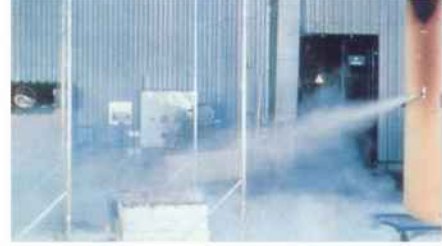
HFC Tipi Sıvının 700°C sıcak metal yüzeye püskürtüldüğü an
