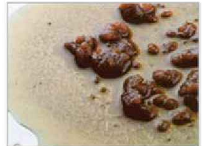
Birleşerek büyük parça oluşumu farklı yağların birleşmesi sonucu oluşur. Kaynak: Krauss Maffei
