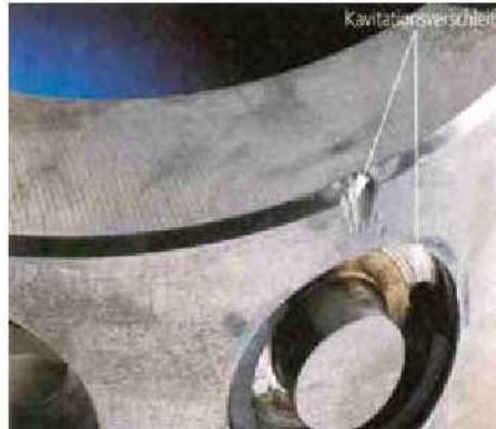
Resim 1. Hava kabarcıklarının neden olduğu hasarlar
